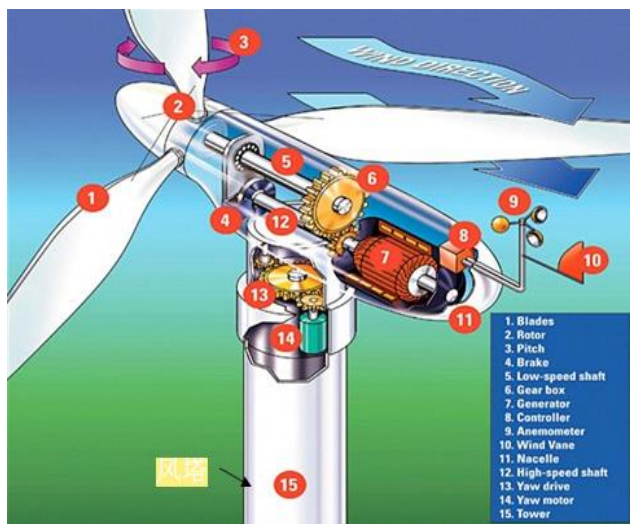
图 22：风塔是整套风机的支撑
