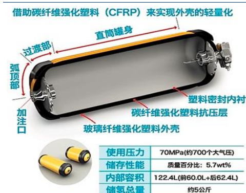
图 6：车载储氢瓶由多层特殊材料组成
