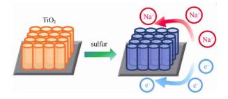
由于锂离子电池负极石墨材料具有较窄的层 间距,无法进行钠离子的可逆嵌脱,因此对于钠离 子电池的负极材料的研究也变得十分必要。TiO2 具有较高的理论比容量 355 mA·h/g ,较宽阔的钠离 子脱嵌通道 0.372 nm\*0.378 nm, 是作为钠离子电 池负极材料的候选材料之一,但是由于 TiO2 的电 导率低,即便做一层碳包覆的纳米结构或者纳米 片,也无法完全发挥其电化学性能。近日,苏州大 学和德国普朗克固态研究所研究人员开发了一种 阳极氧化制备硫掺杂的 TiO<sub>2</sub> 纳米管阵列,该自支 撑的阵列管道结构不仅可以提供更多的反应活性 表面,而且S掺杂可以大幅度提高电子电导率(提 升了 3 个数量级 ) , 因此 , 该结构的  $TiO_2$  具有强 大的储钠性能, 小电流密度下克容量最高达 320 mA·h/g,接近理论克容量,以3.35 A/g(10C)的 电流密度循环 4000 次后容量保持率为 91%。
